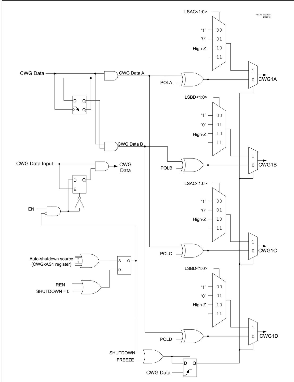
**FIGURE 24-4: CWG1 PUSH-PULL MODE OPERATION**
