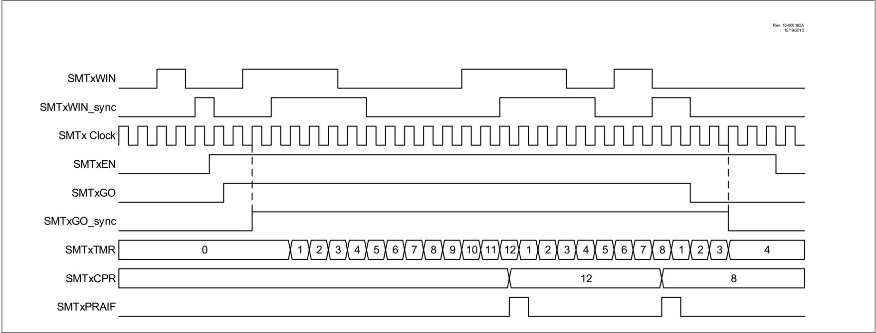
**FIGURE 25-11: WINDOWED MEASURE MODE SINGLE ACQUISITION TIMING DIAGRAM**
