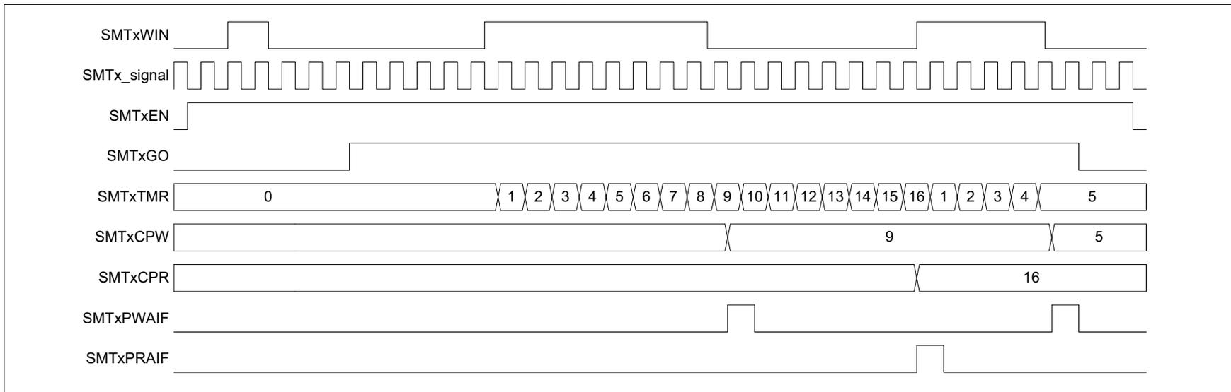
**FIGURE 25-22: WINDOWED COUNTER MODE SINGLE ACQUISITION TIMING DIAGRAM**
