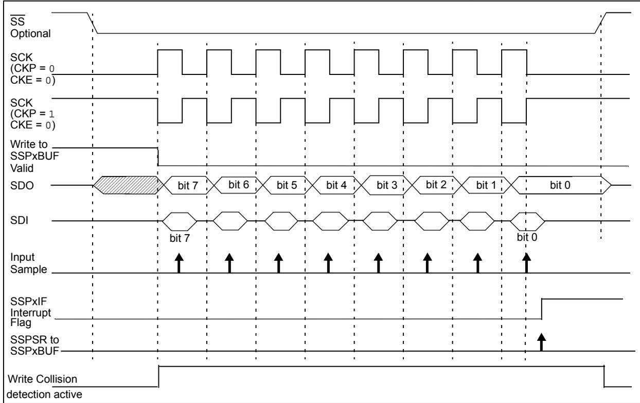
**FIGURE 27-8: SPI MODE WAVEFORM (SLAVE MODE WITH CKE = 1)**
