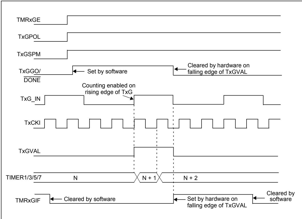
**FIGURE 19-7: TIMER1/3/5/7 GATE SINGLE-PULSE AND TOGGLE COMBINED MODE**
