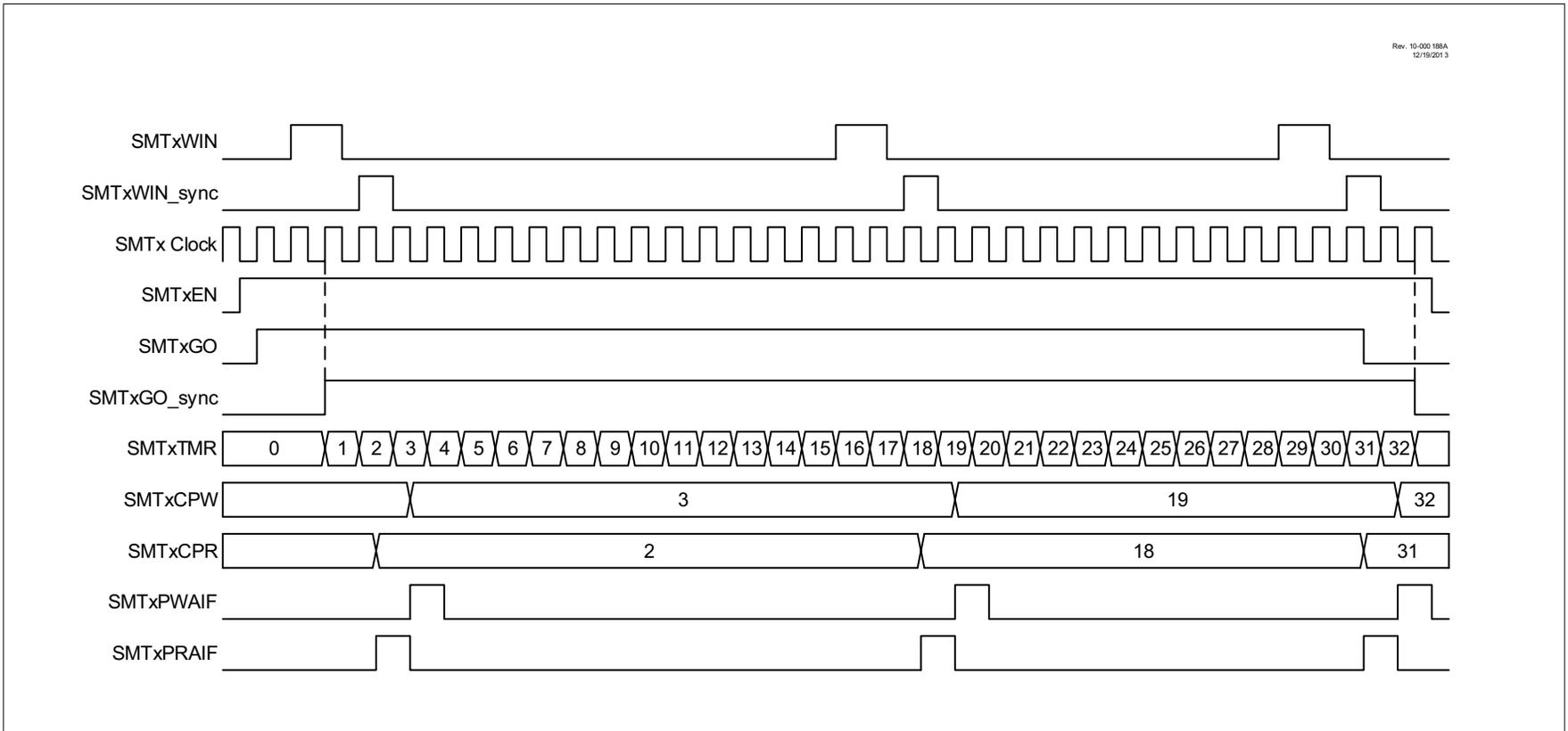
**FIGURE 25-17: CAPTURE MODE SINGLE ACQUISITION TIMING DIAGRAM**
