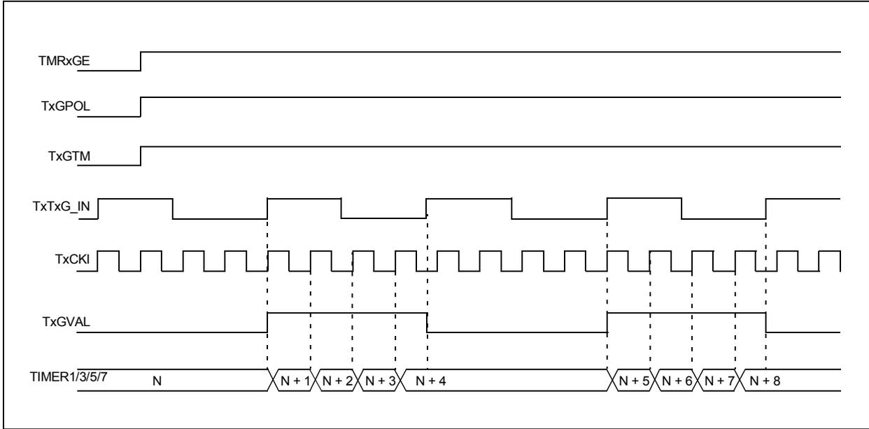
**FIGURE 19-6: TIMER1/3/5/7 GATE SINGLE-PULSE MODE**
