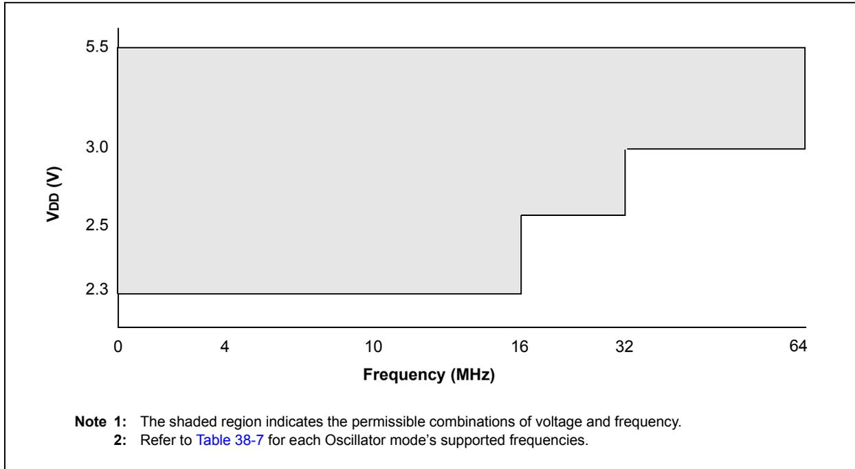
**FIGURE 38-2: VOLTAGE FREQUENCY GRAPH,  $-40^{\circ}\text{C} \leq T_A \leq +125^{\circ}\text{C}$ , PIC18LF67K40 ONLY**
