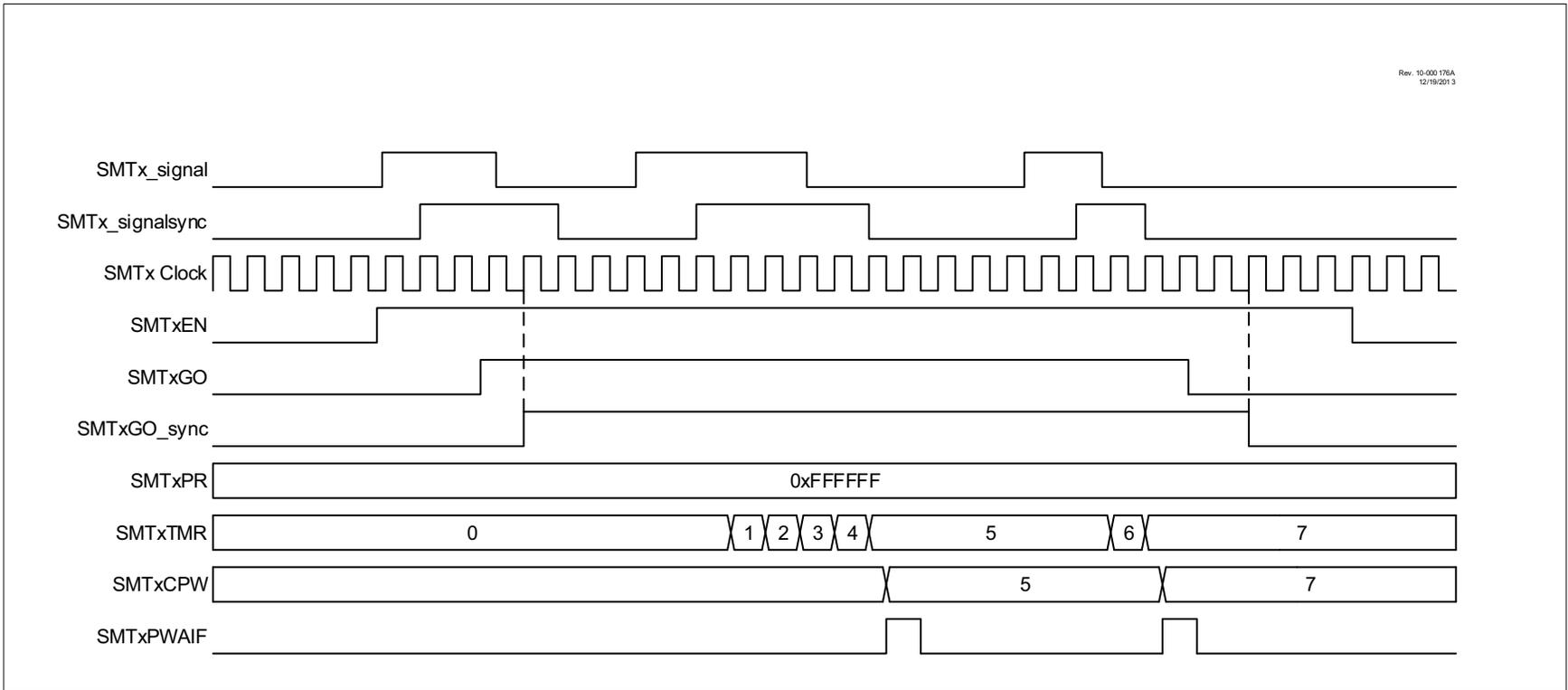
**FIGURE 25-5: GATED TIMER MODE SINGLE ACQUISITION TIMING DIAGRAM**
