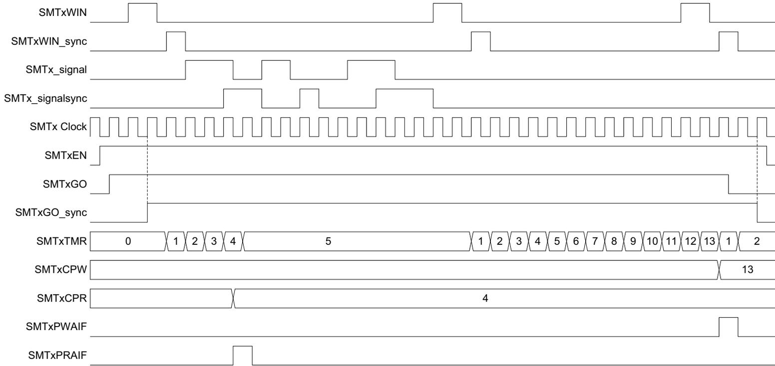
**FIGURE 25-15: TIME OF FLIGHT MODE SINGLE ACQUISITION TIMING DIAGRAM**
