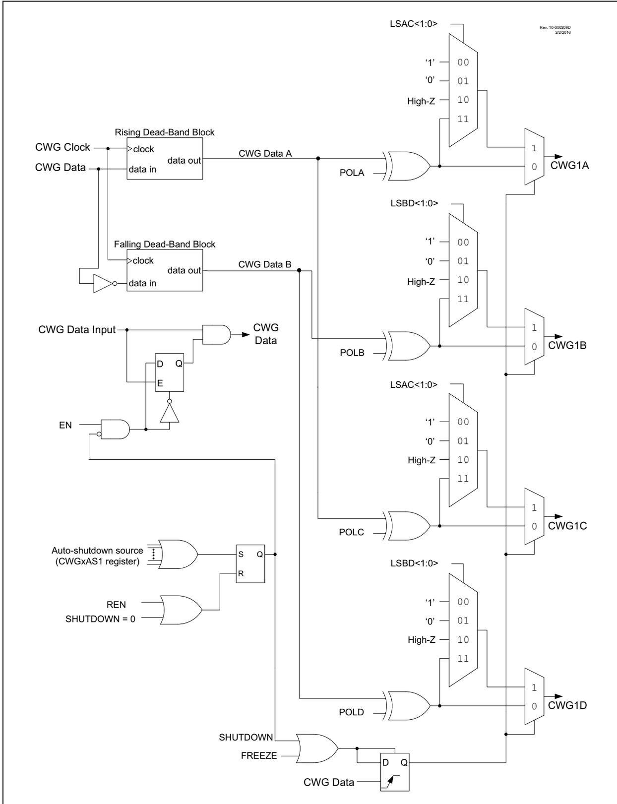
**FIGURE 24-2: CWG1 HALF-BRIDGE MODE OPERATION**
